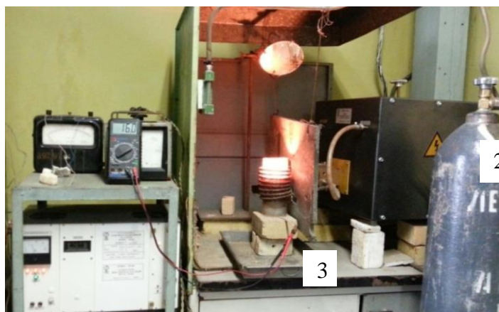
1- транзисторный генератор 1 :окочастотный; 2- блок нагревательного контура; 3- индуктор Рис.1. Схема установки индукционного нагрева
