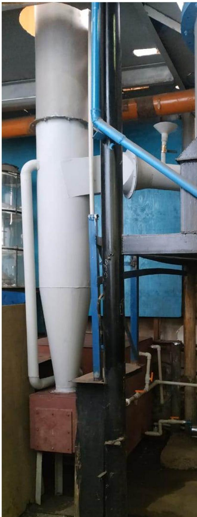
Рисунок 2.3 - Аппарат циклонно-вихревого действия и его составные части
