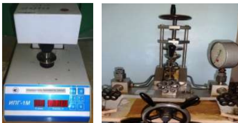
Рисунок 2.1 - Приборы для измерения статической прочности гранулы марок ИПГ-1М и МП-60
