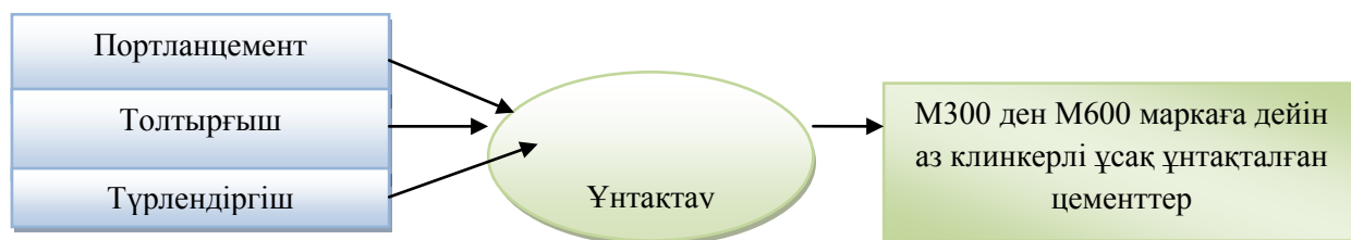
1 – сурет. Ұсақталған аз клинкерлі цемент өндірісінің принципіалды сызба нұсқасы
