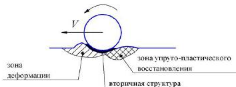
Рисунок 2 – Контакт материалов в паре трения «диск–плоскость»
