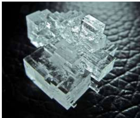
Сурет 2. Тазартылған суда қайта кристалданған натрийдің хлоридінің кристалдары
