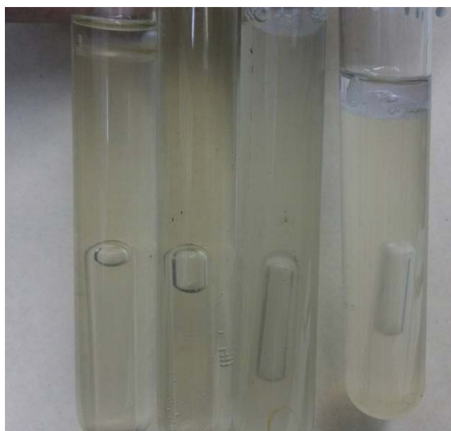
Рисунок 1 – Рост и газообразование на минеральной среде с глицерином (10% глицерина, 1 г/л K_2HPO_4 , 1 г/л нитрат аммония) в анаэробных условиях
