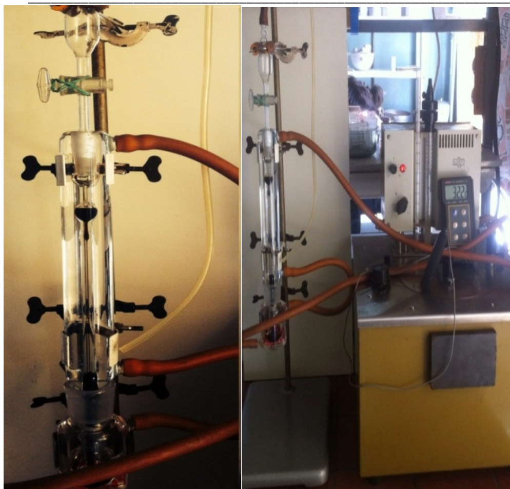
Рисунок 4 – Схема установки с термостатируемым капиллярным вискозиметром
