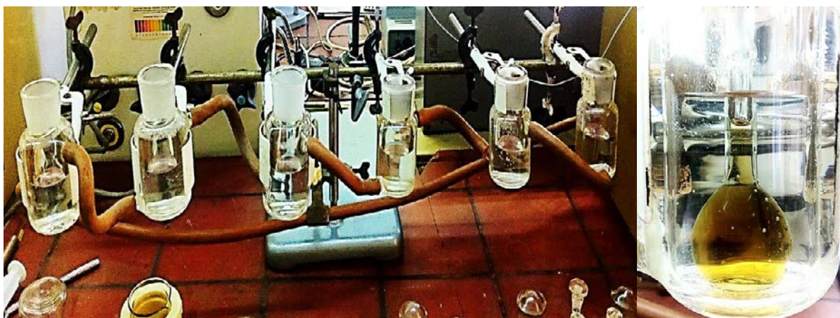
Рисунок 6 – Термостатирование измерительных сосудов
