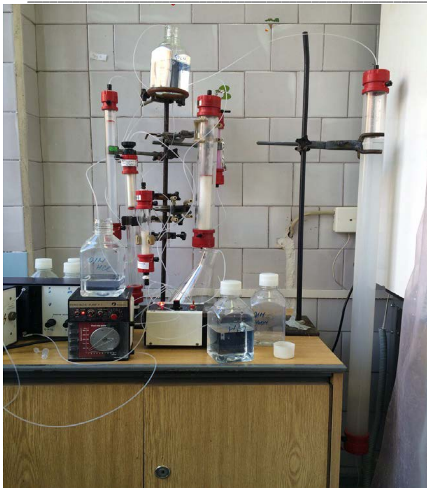
Рисунок 4 – Установка для гель-фильтрации
