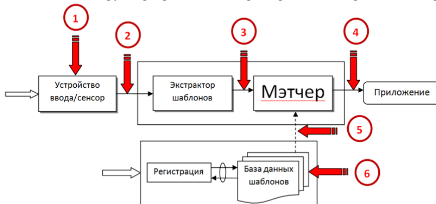
Рис. 3. Точки атак на биометрические системы
