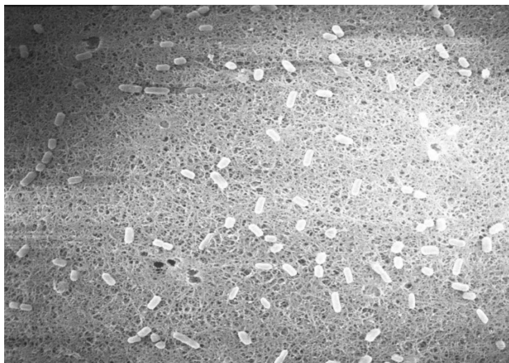
Рисунок 6 - СЭМ поверхность сорбента с иммобилизованными клетками Lactobacillus после 5 циклов
