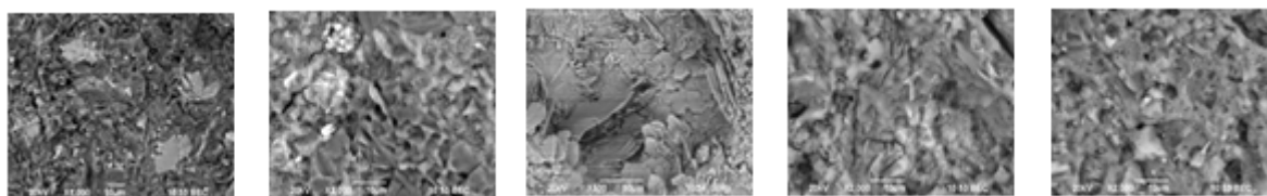
Рисунок 4 – микрофотографии со сколов затвердевшего цементного камня:
