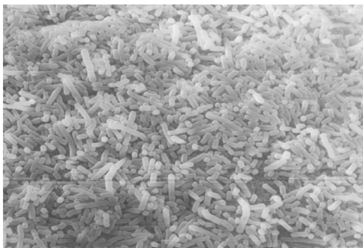
Рисунок 5 - СЭМ поверхность сорбента с иммобилизованными клетками Lactobacillus до использования
