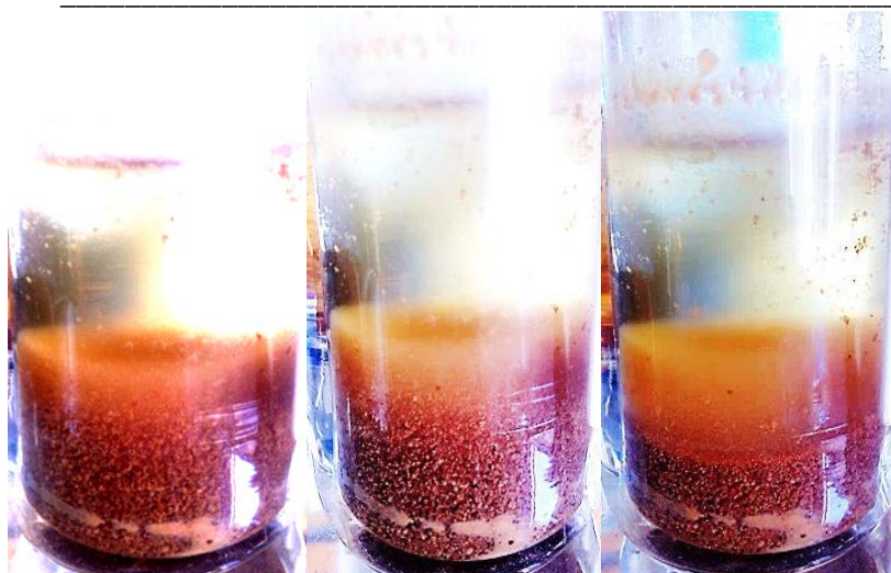
Рисунок 8 – Разрушение гранул носителя LipozymeRMIM
