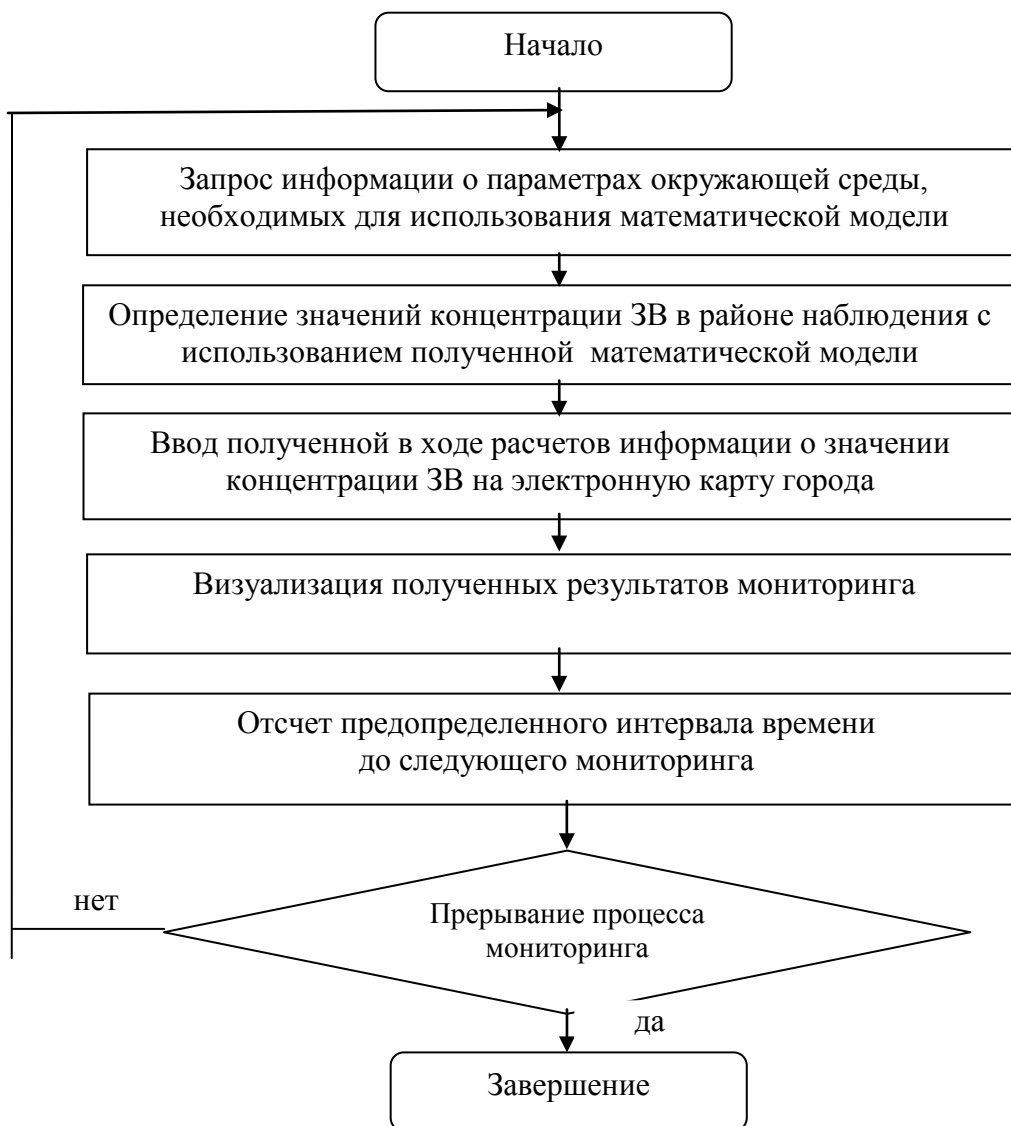
Рисунок 2. Алгоритм функционирования системы экологического мониторинга
