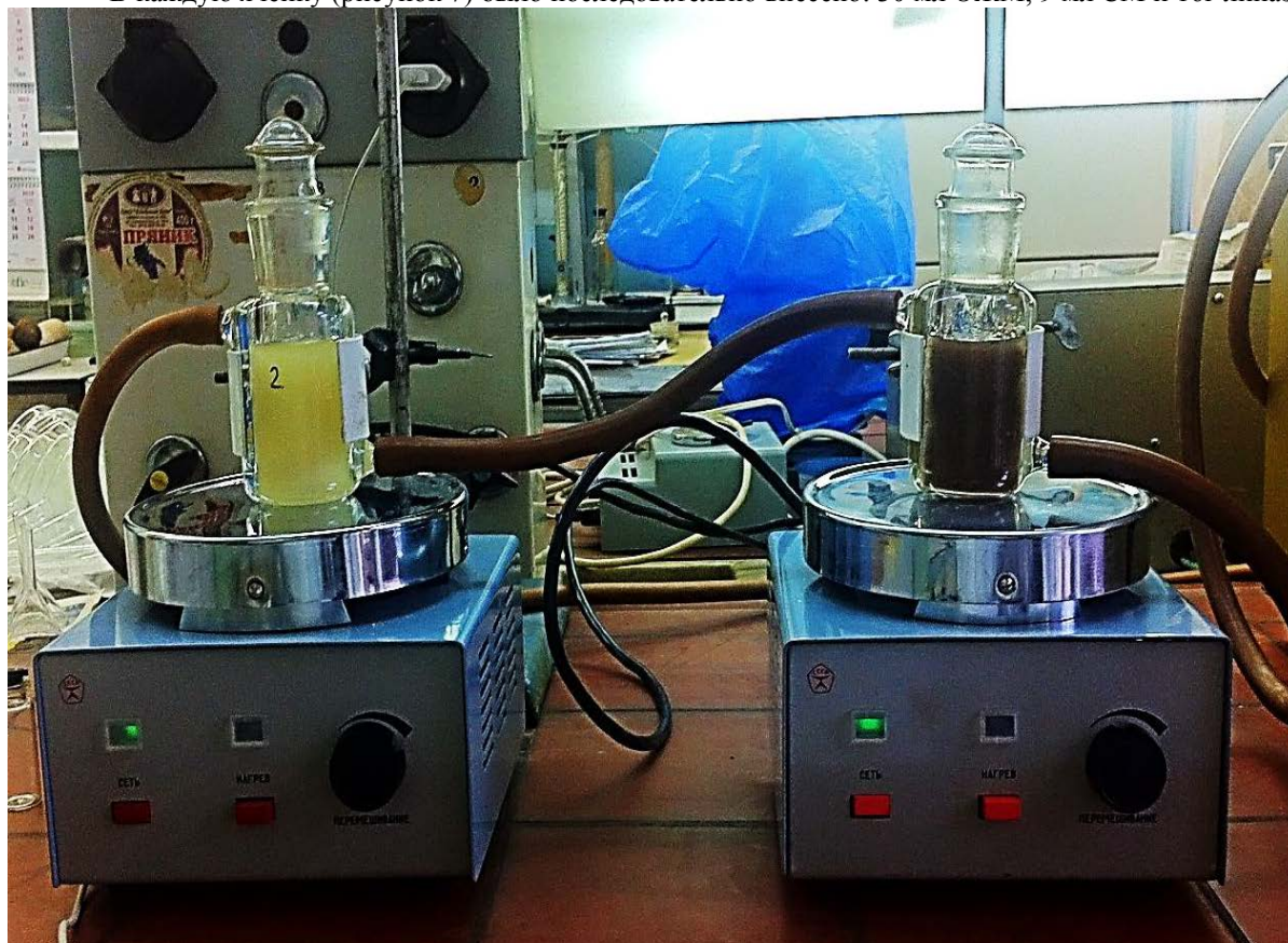
Рисунок 7 – Процесс биокаталитической переэтерификации с применением КПЛ Novozym 435 (слева) и LipozymeRMIM (справа)
