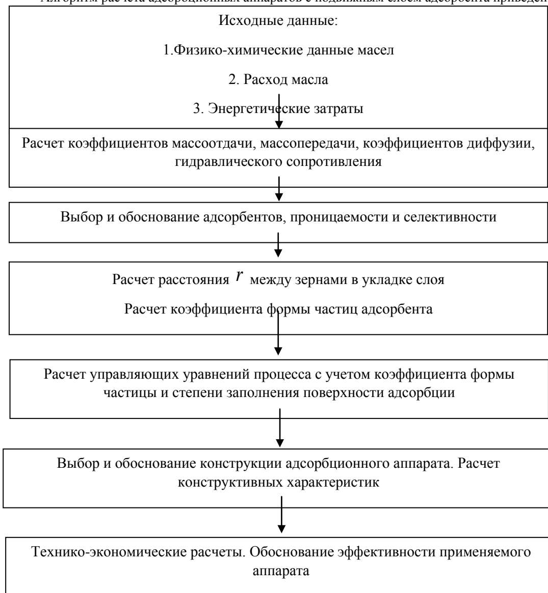
Рисунок 1 – Алгоритм расчета адсорбционных аппаратов
