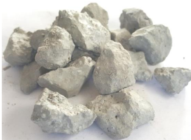
Рисунок 2.25 - Общий вид литого электротермофосфорного шлака
