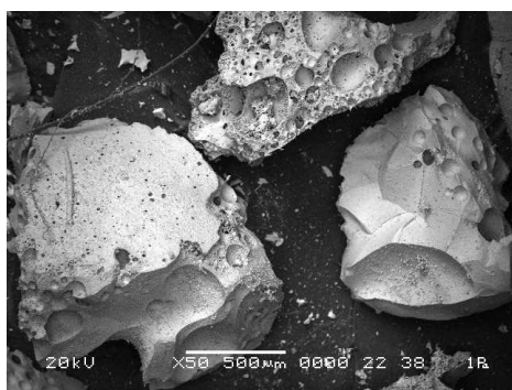
Рисунок 2.24 - Общий вид гранулированного электротермофосфорного шлака, увеличение в 50 раз
