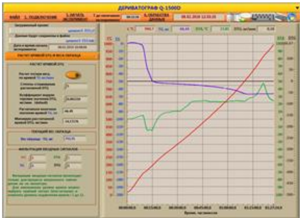
Рисунок 2.7 - Экспериментальная установка по определению огнетушащей способности порошковых материалов проб цементного завода методом дифференциалотермографического анализа (ДТА)
