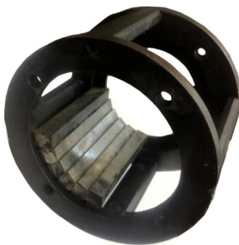
Рисунок 4.6 – Корпус зеерной камеры с пластинами
