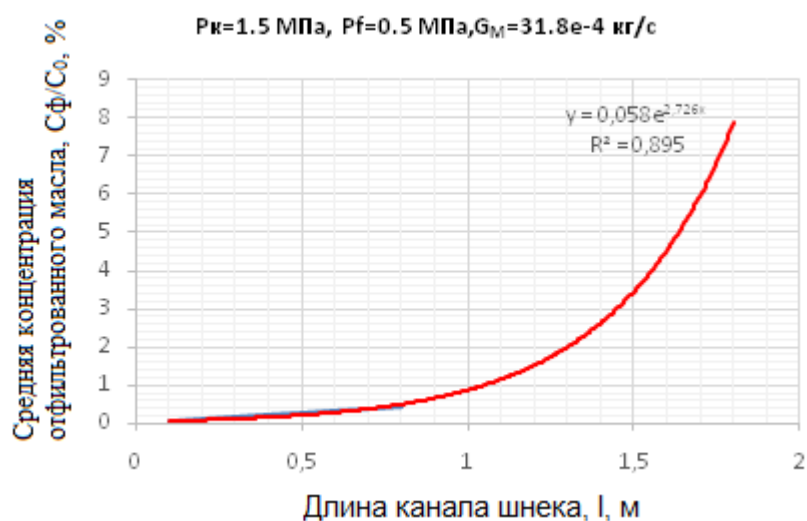
Рисунок 3.7 – Изменение средней концентрации отфильтрованного масла по длине канала шнека
