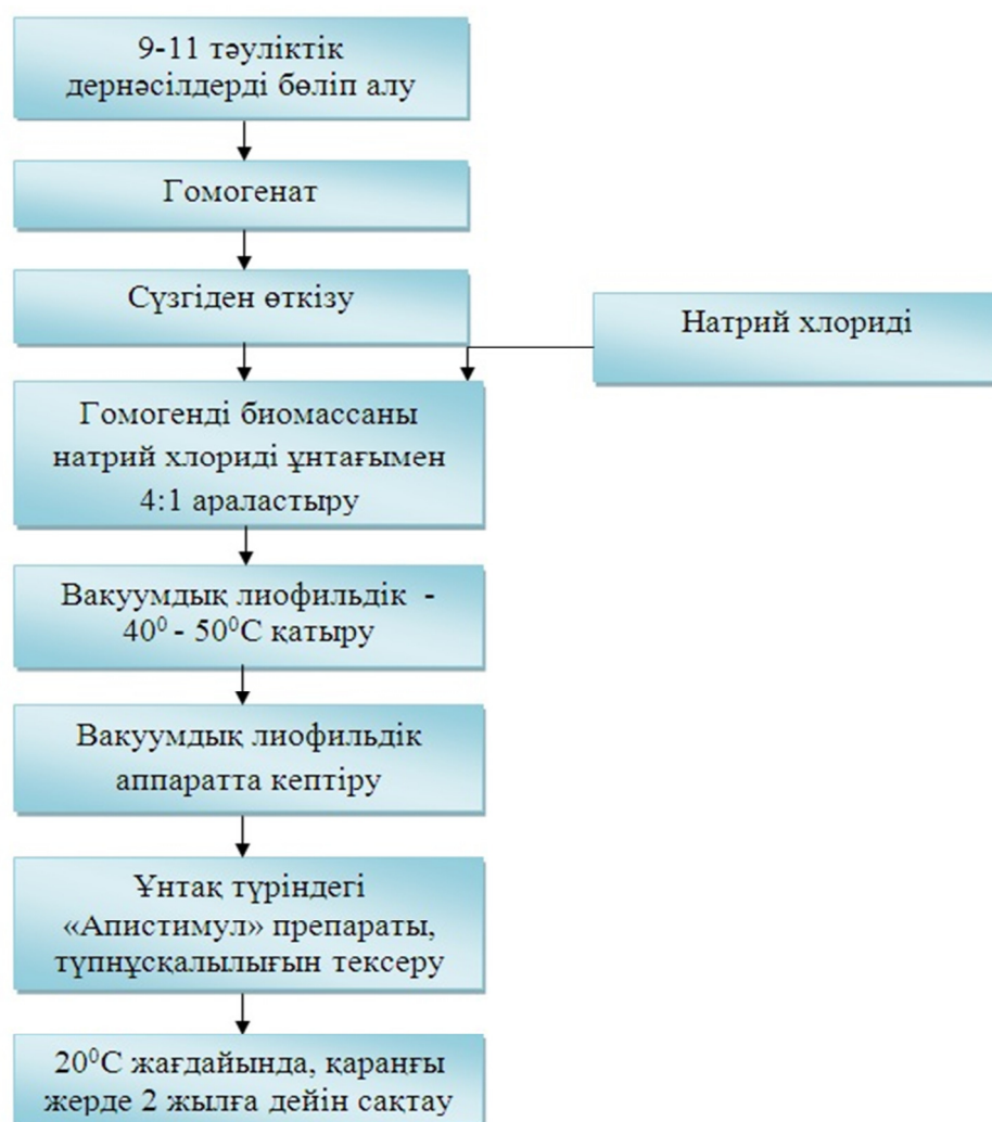
Сурет 18 – «Апистимул» препаратын өндірудің принципіальды технологиялық сызба-нұсқасы
