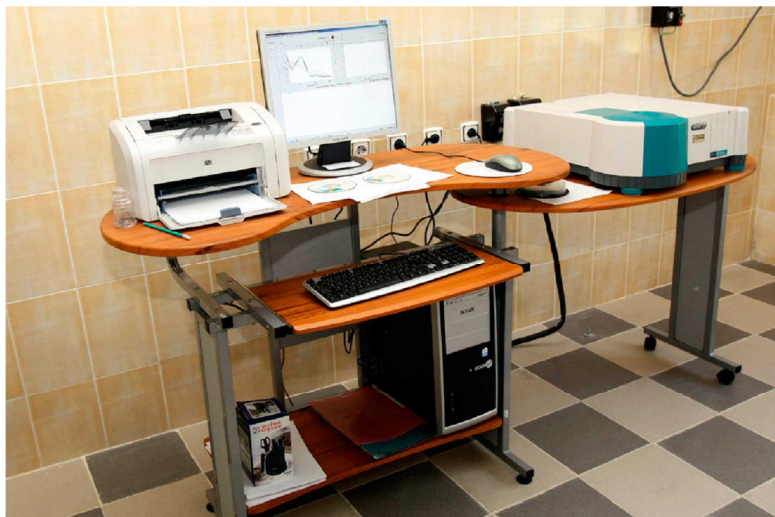
Сурет 7 - Екі сәулелі Varian «Cary-50» спектрофотометрі
