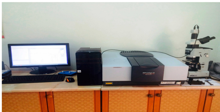
Сурет 9 – IR Prestige-21 (Shimadzu) маркалы ИҚ-фурье спектрометрі
