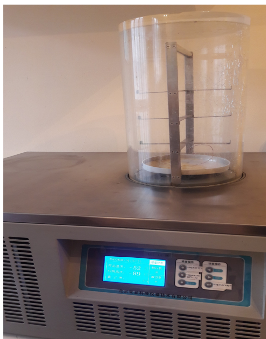
Сурет 5 – Вакуумдық лиофильдік кептіруге арналған құрал
