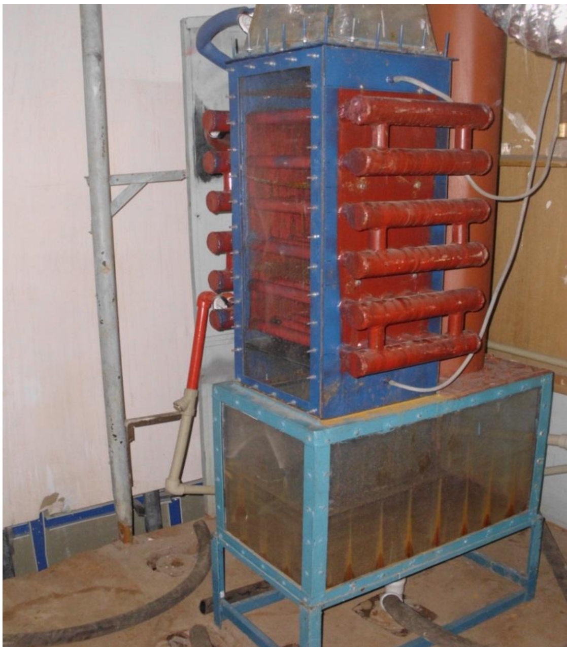
Рисунок 2.4 – Аппарат с комбинированной регулярно-взвешенной насадкой (вид сбоку)
