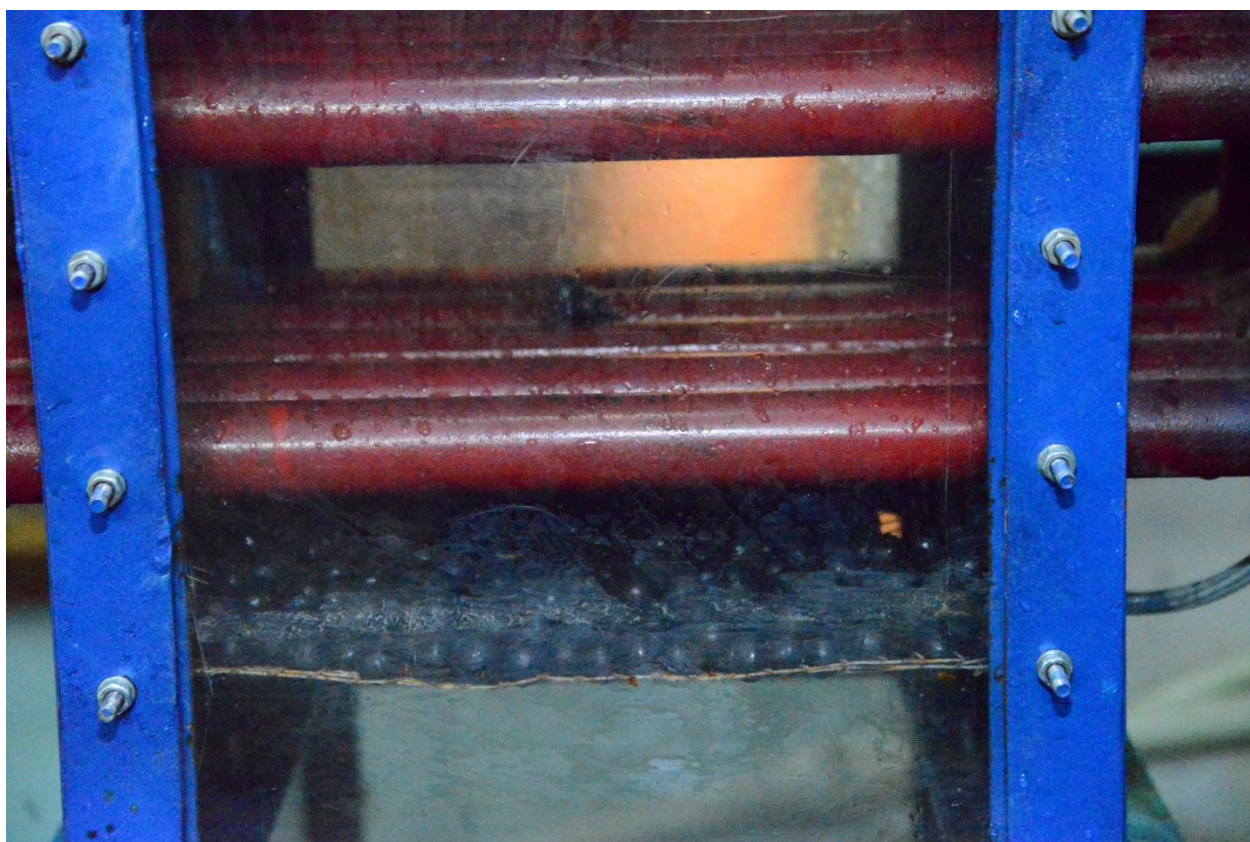
Рисунок 2.13 – Фотографии слоя дискретных шаровых элементов, расположенных на плоской опорно-распределительной решетке при скорости газового потока от 1 до 5 м/с, лист 1
