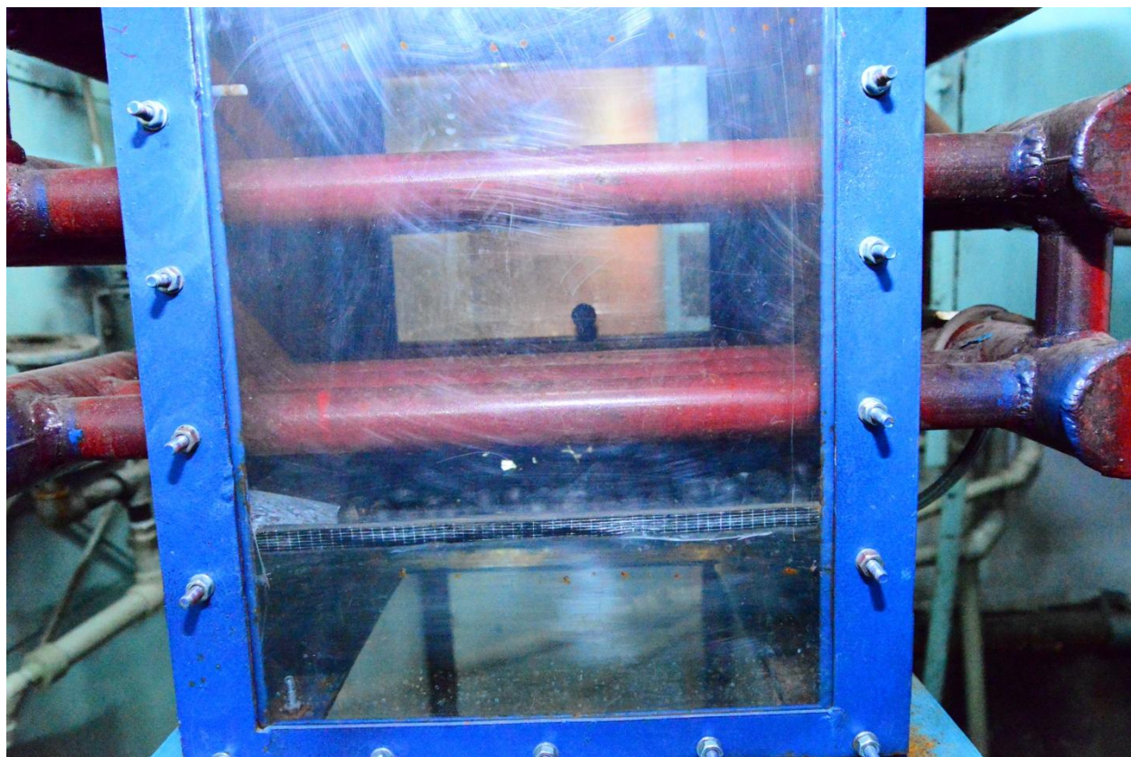
Рисунок 2.15 – Фотографии слоя дискретных шаровых элементов, расположенных на пирамидальной опорно-распределительной решетке при скорости газового потока от 1 до 5 м/с, лист 1
