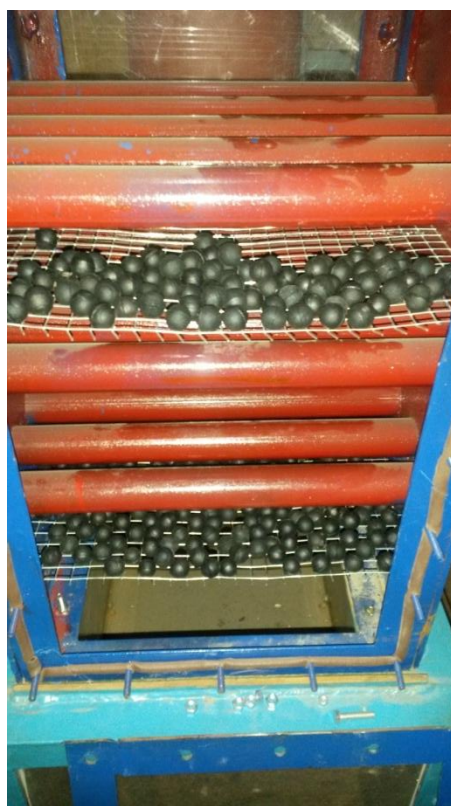
Рисунок 2.6 – Рабочая зона аппарата с трубчато-взвешенной насадкой (загрузка дискретными контактными элементами (шарами))
