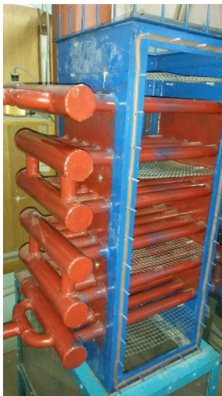
Рисунок 2.5 – Рабочая зона аппарата с трубчато-взвешенной насадкой (плоские опорно-распределительные решетки)
