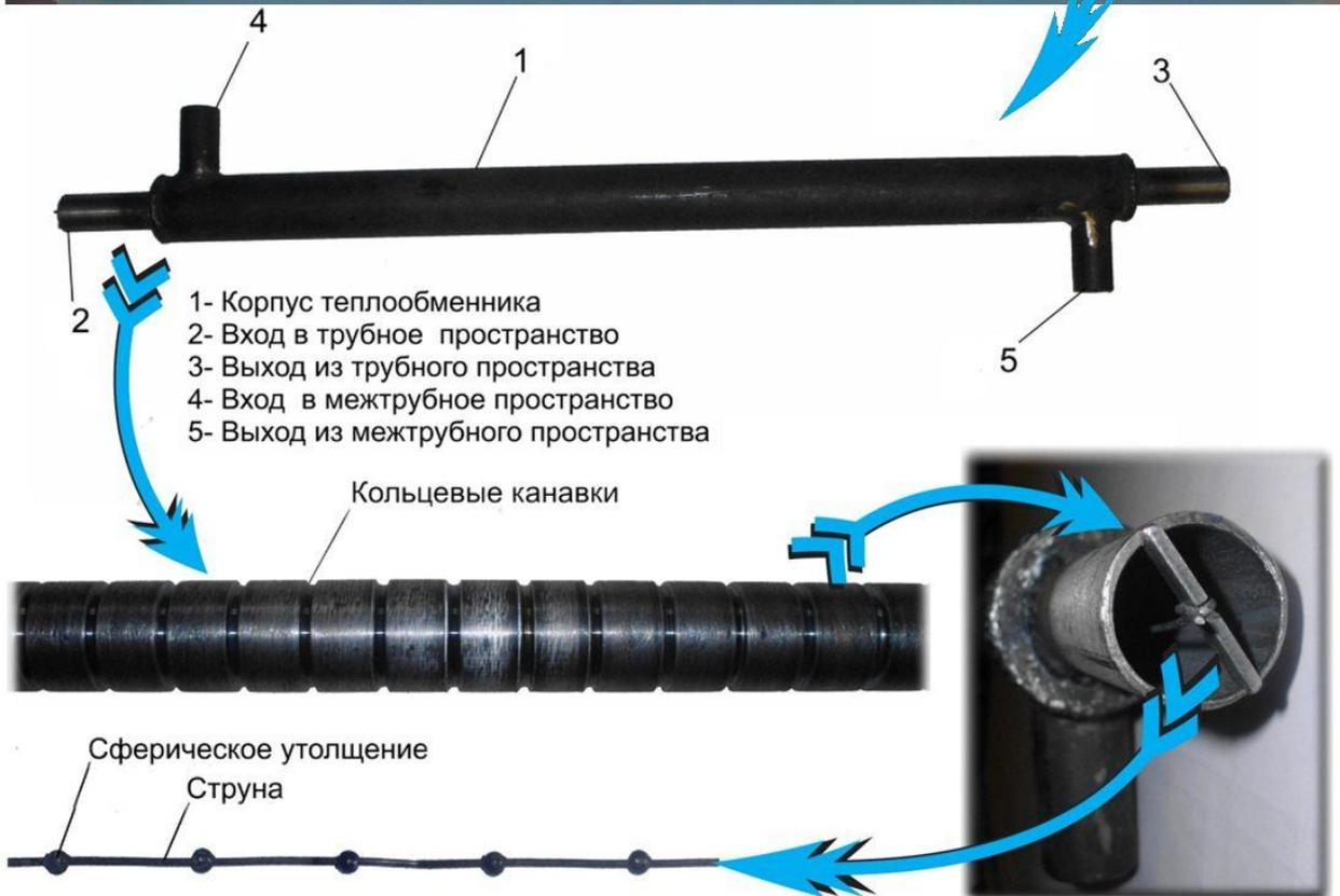
Рисунок 2.2 – Общий вид экспериментальной установки с теплообменником с накатанными трубами и турбулизатором ядра потока.
