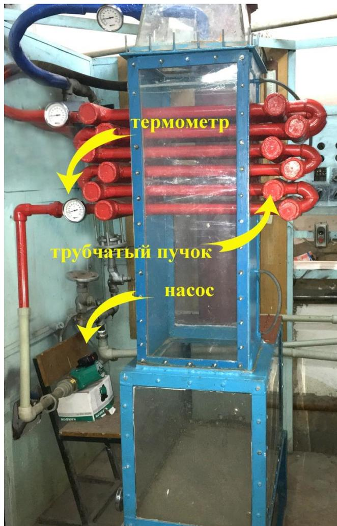
а) общий вид экспериментальной установки,
