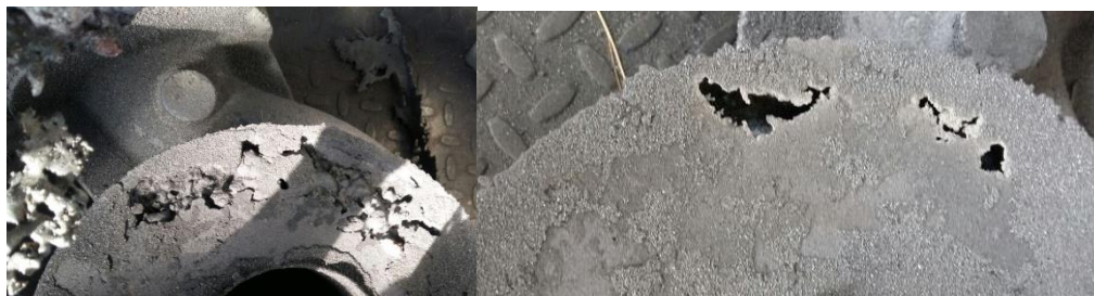
Рис.2 Дефект отливки - трещины
