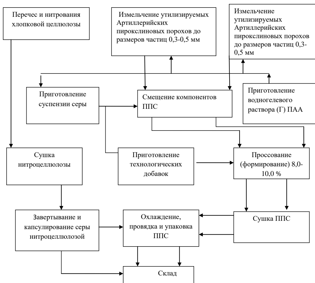
Рисунок 1 - Принципиальная схема производства пиротехнических пестицидных составов (ППС)
