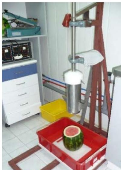
Рисунок 1.9 - Устройство для выделения мякоти арбуза, тест-вертикальный срез
