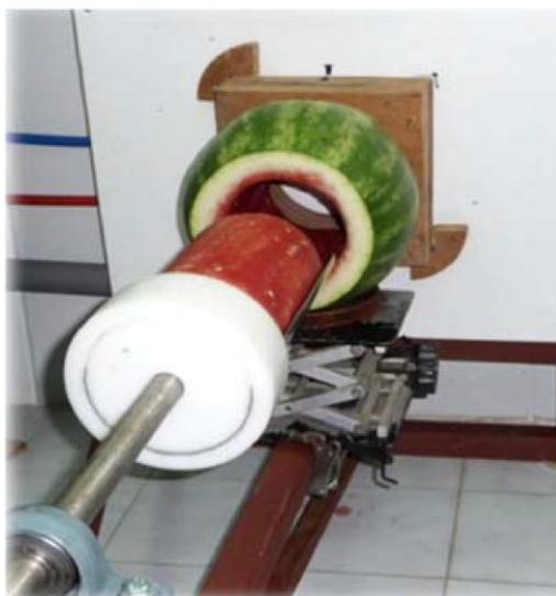
Рисунок 1.10 - Тест нарезки в горизонтальном режиме
