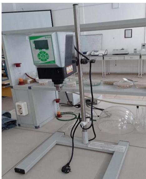
Рисунок 3.1- Верхнеприводное перемешивающее устройство ПЭ 8300
