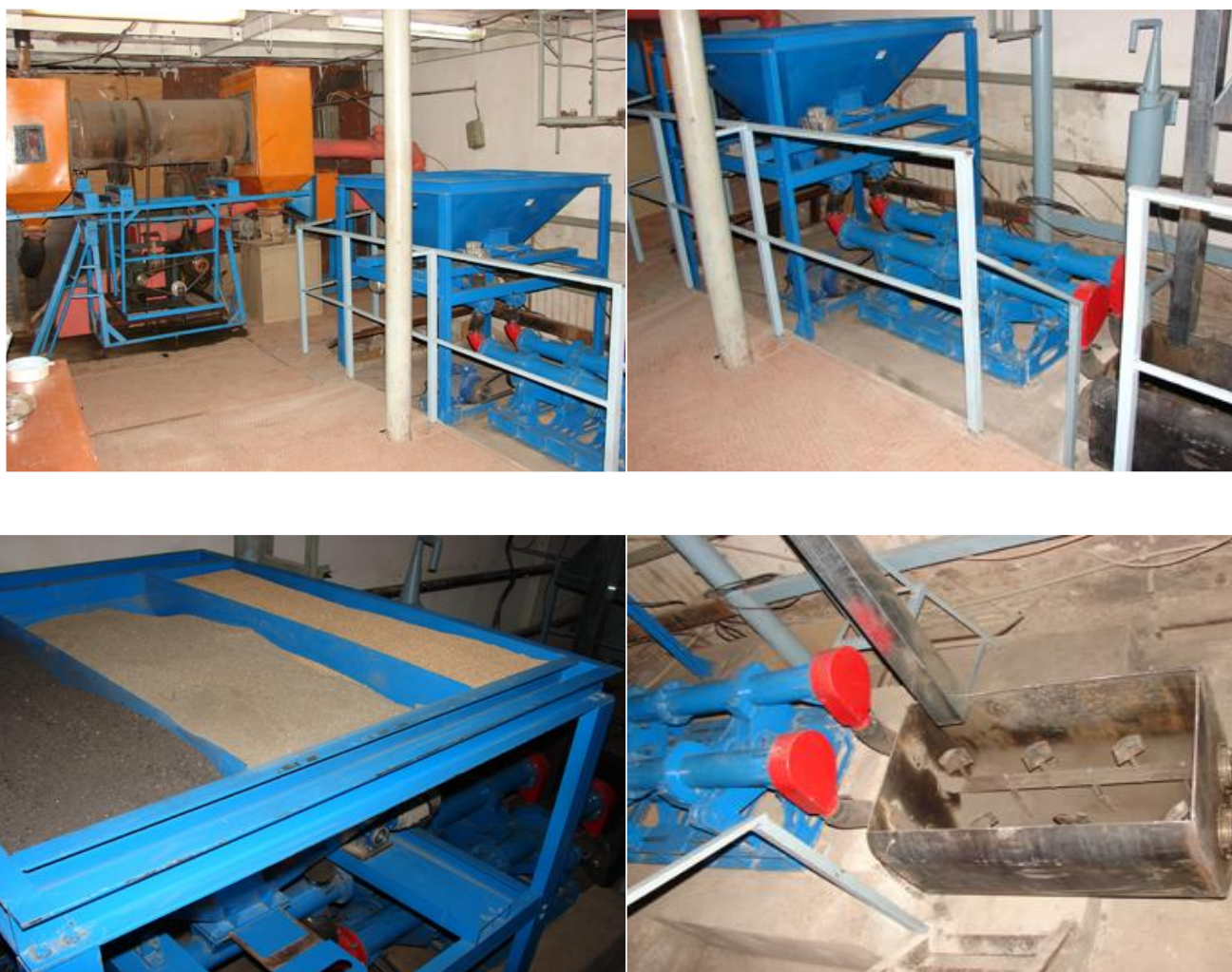
Сурет 27 - "ЖАМБ-70" күрделі аралас тыңайтқышты алудың қондырғысының аппаратуралық үлгісі.
