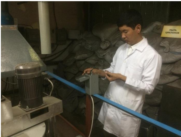
Сурет 31 - «ЖАМБ-70» минералды тыңайтқышты өндіру барысында ауадағы газдың мөлшерін анықтау
