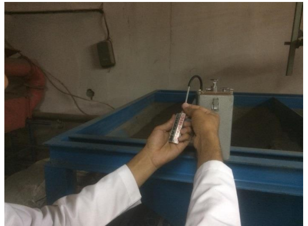
Сурет 31 - «ЖАМБ-70» минералды тыңайтқышты өндіру барысында ауадағы газдың мөлшерін анықтау
