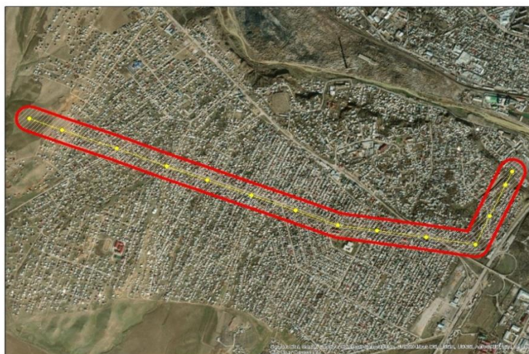
Рисунок 18 - Зона заражения электромагнитным излучением, порождаемым низкочастотными энергетическими объектами, напряжением 220 кВ, расположенная в микрорайоне Казыгурт
