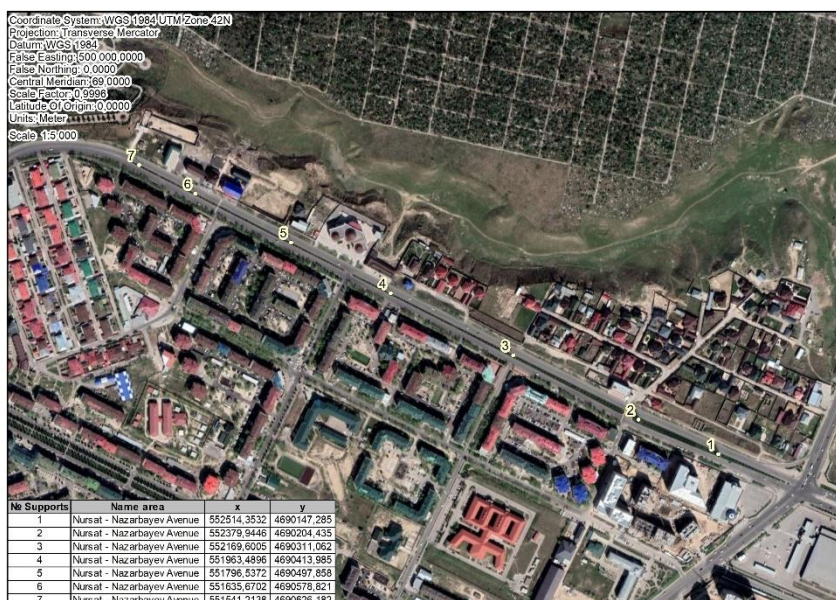
Рисунок 7 - Геоинформационная карта с обобщенными координатными данными высоковольтных линий электропередачи на примере микрорайона Нұрсәт и проспекта Назарбаева.
