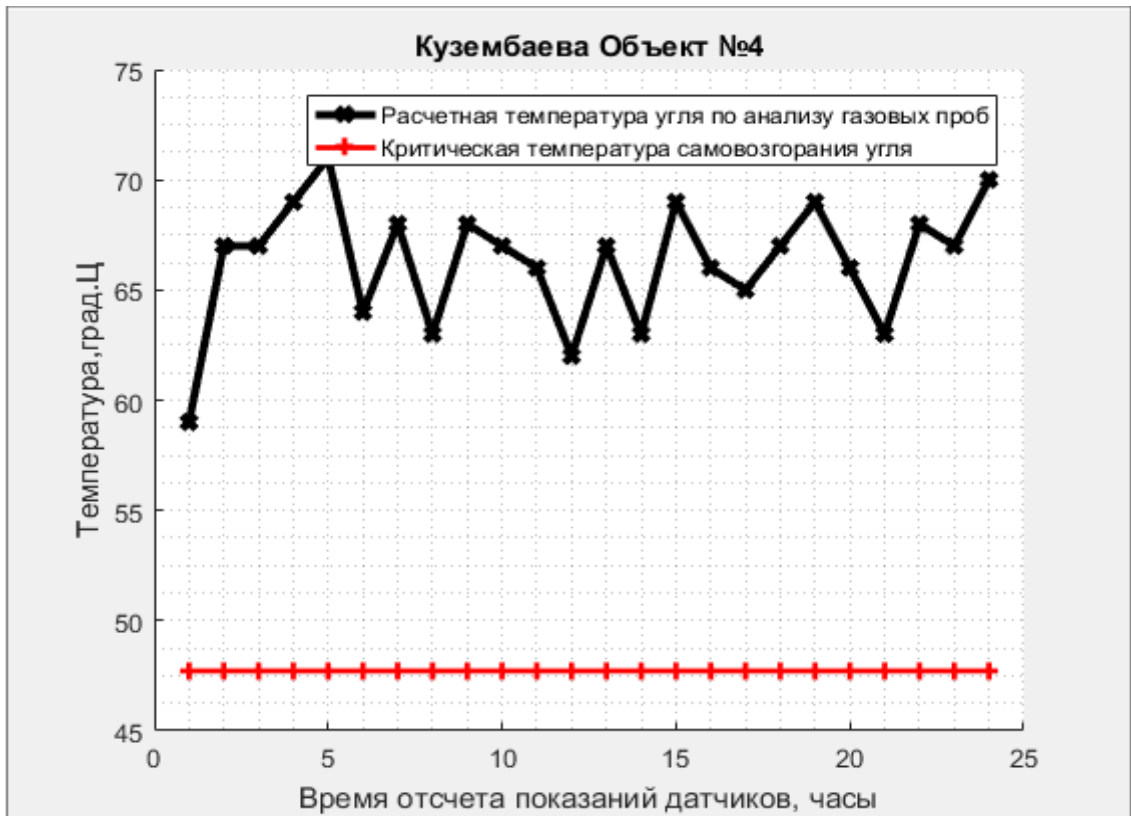
4.11-сурет – Газдардың шоғырлануы датчиктерінің көрсеткіштері бойынша көмірдің өздігінен қызуы температурасының өзгеру кестесі
