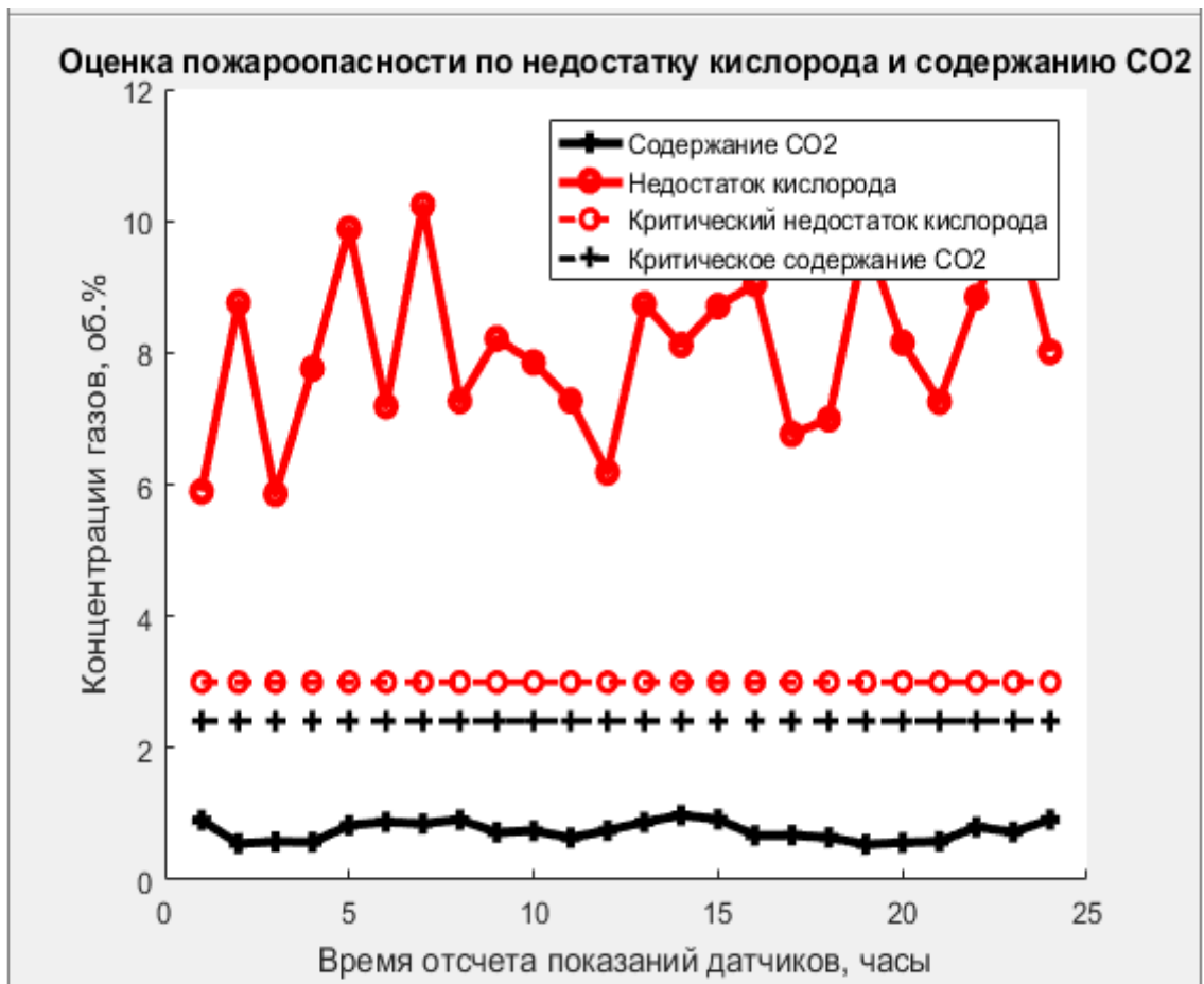
4.15-сурет – Датчиктердің көрсеткіштері бойынша тотығу процесінің динамикасын талдауға арналған графиктер
