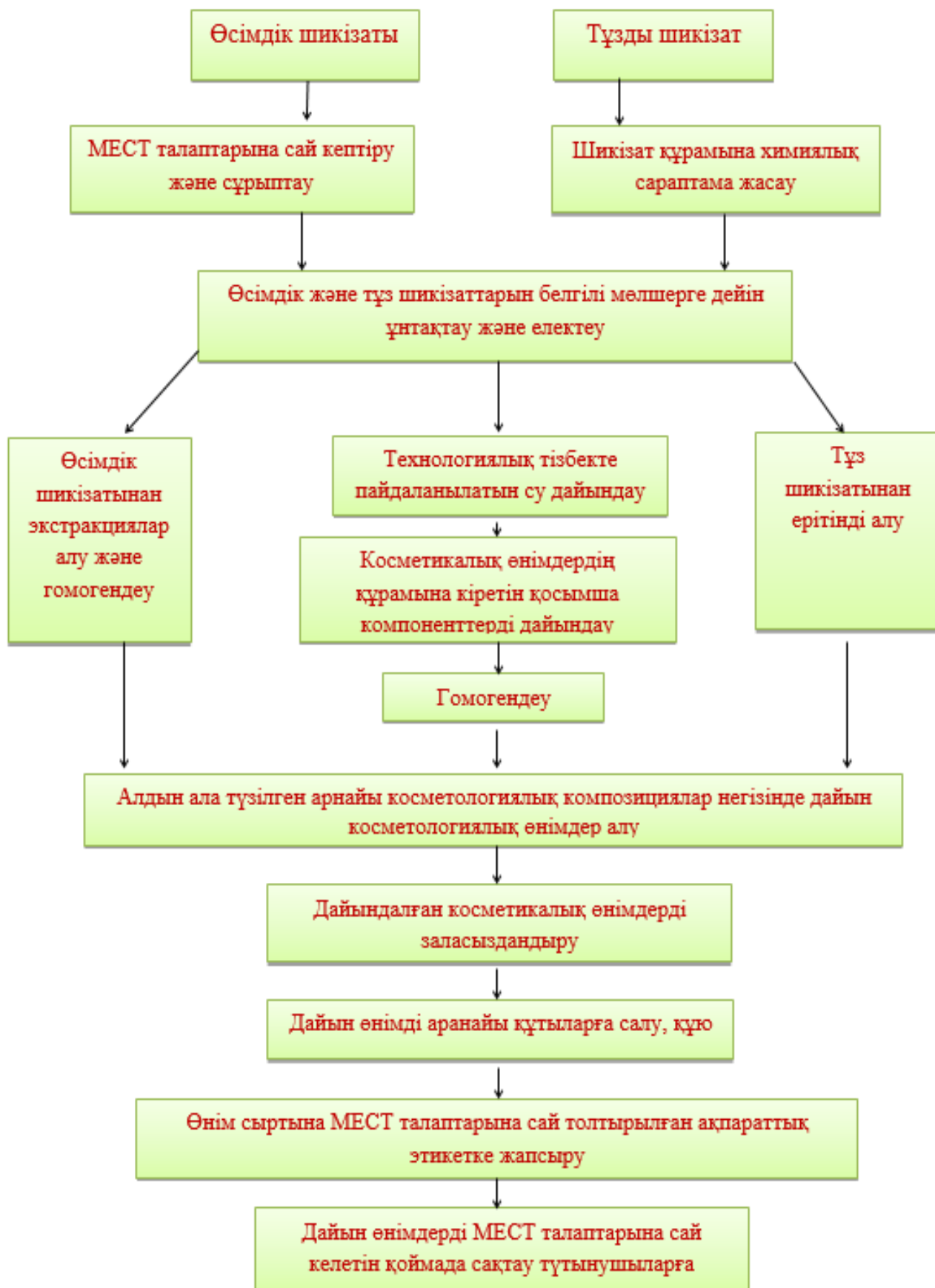
Сурет 38 – Косметологиялық өнім алудың технологиялық сызбасы
