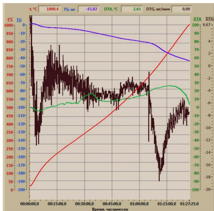
Сурет 2.14 – Шилісай кен орны төменсұрыпты фосфориттерінің дериватограммасы
