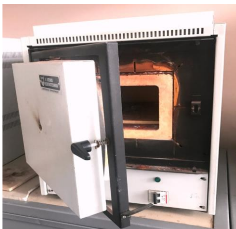
Рисунок 20 – Муфельная печь для проведения процесса обжига (прокалки) при высоких температурах
