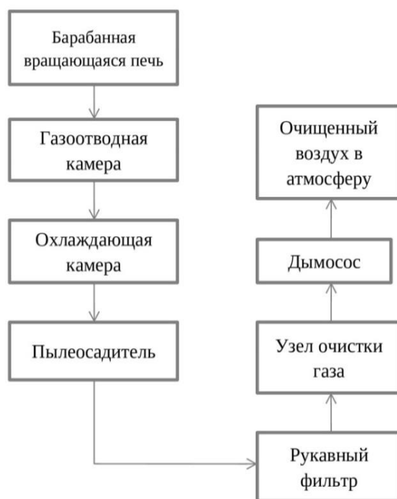
Рисунок 26 – Технологическая схема способа извлечения оксидов свинца и цинка
