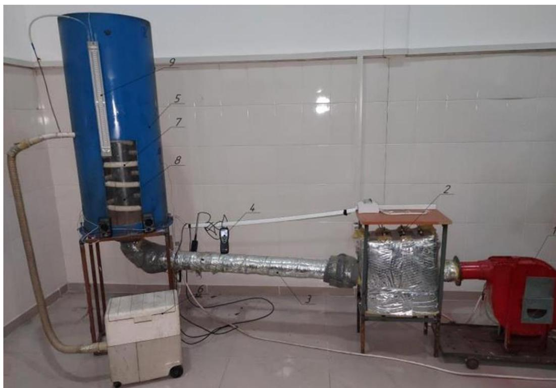
1 – нагнетательный вентилятор; 2 – калорифер; 3 – магистральный трубопровод; 4 – анемометр testo 416; 5 – корпус; 6 – всасывающий вентилятор; 7 – всасывающий спираль; 8 – центральная перфорированная газораспределительная труба; 9 – мановакуумметр для измерения величины разрежения
