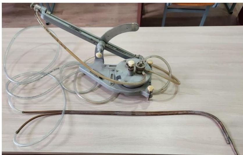
Рисунок 3.4 – Микроманометр ММН с трубкой Пито
