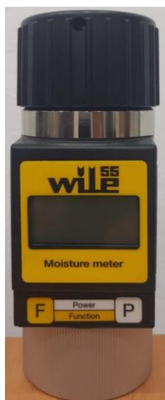
Рисунок 3.13 - Портативный измеритель влажности марки WILE 55
