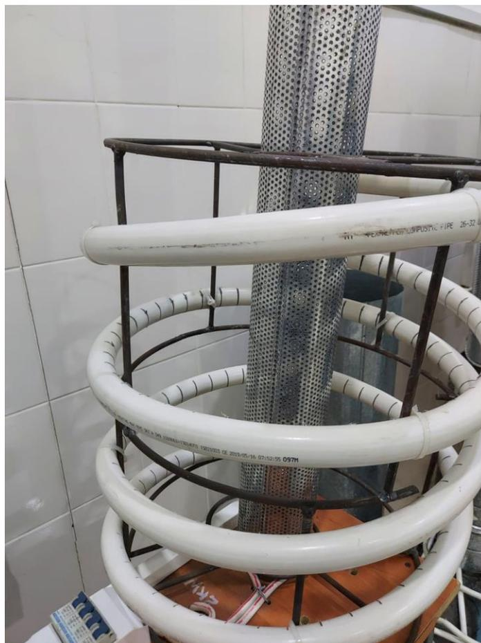
Рис. 3.10 – Газораспределительная и спиралевидная труба
