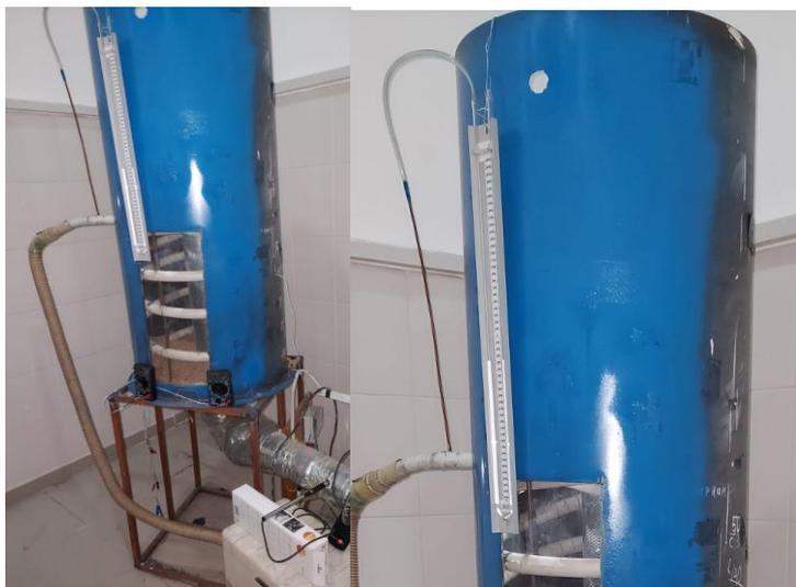
Рисунок 3.16 – Мановакууметр установленный в сушильной установке
