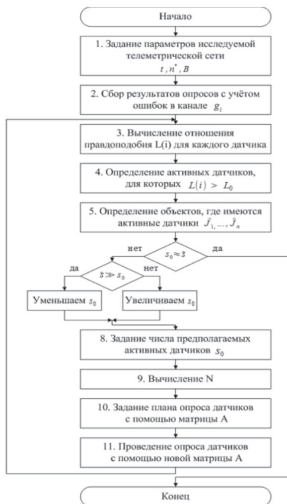
Рисунок 2 – Алгоритм определения объектов, на которых произошла аварийная ситуация
