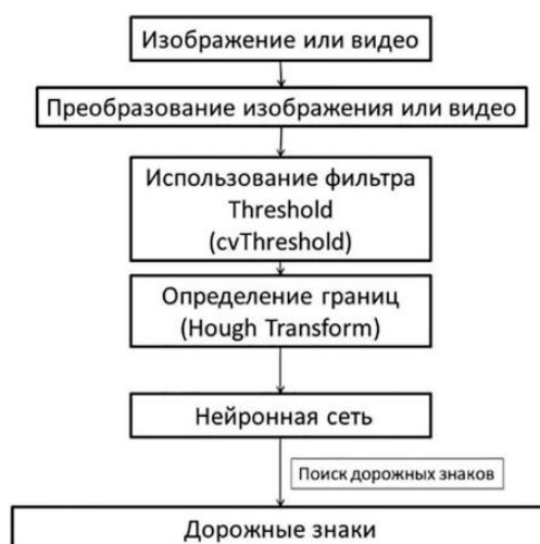
Рисунок 2 – Схема преобразования изображений дорожных знаков
