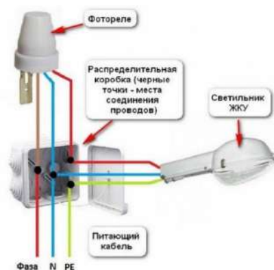
Рис. 3 – Схема автоматического включения и выключения освещения с применением фотореле
