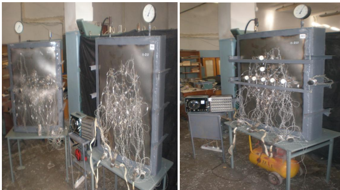
Рисунок 1- Общий вид модели фрагмента стенки резервуара с вмятинами
