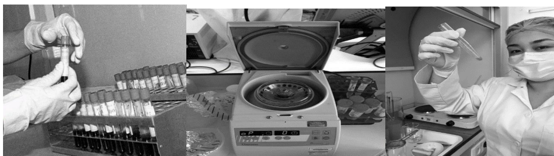
Сурет–2. «Thermo Fisher» зертханалық үстел центрифугасы арқылы қан сарысуын бөліп алу процесі
