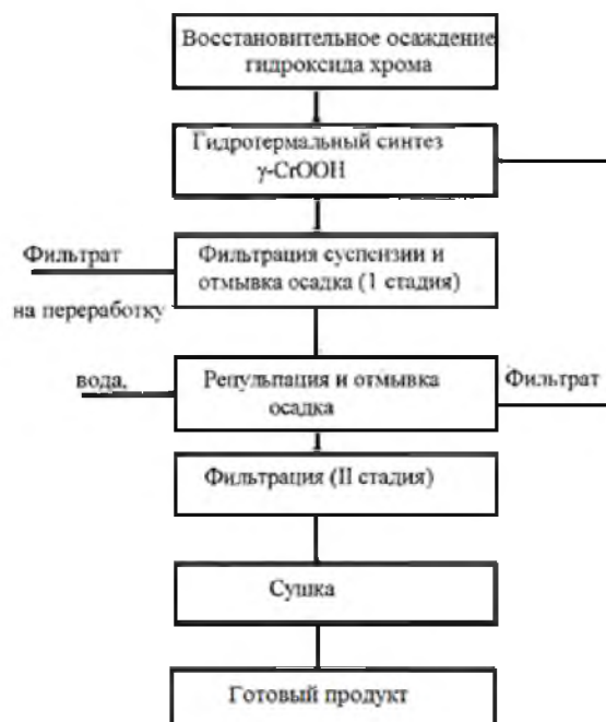
Рисунок 23 – Схема получения хромитового пигмента темно-изумрудного цвета
