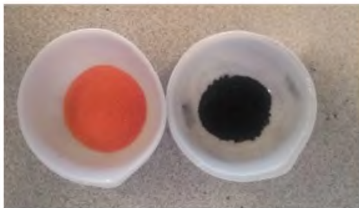
Рисунок 4 – Дихромат калия и активированный уголь, содержащий 15 г углерода в прокаленных углеродсодержащих хромитовых окатышах с поверхностно-активными модификаторами
