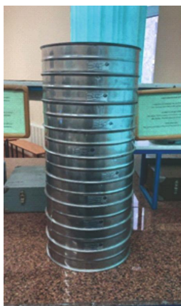
Сурет 19 – Шеңбер саңлаулы електердің (сол жақта) және бөлшектер өлшемдерінің таралуының фотосуреті (оң жақта)
