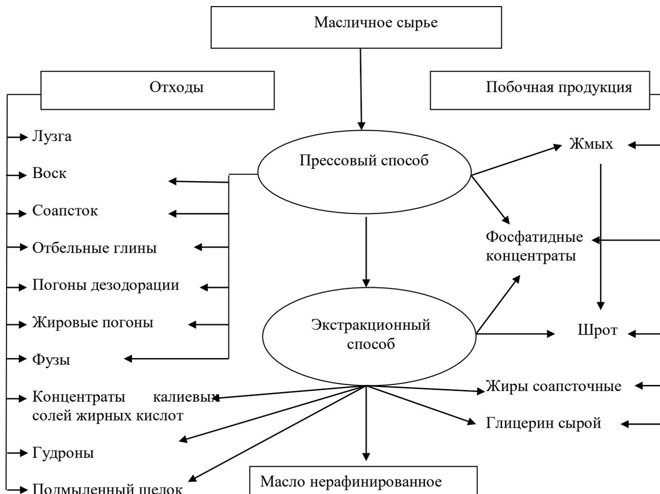
Рисунок 1 – Схема получения отходов и побочной продукции при переработке масличного сырья
