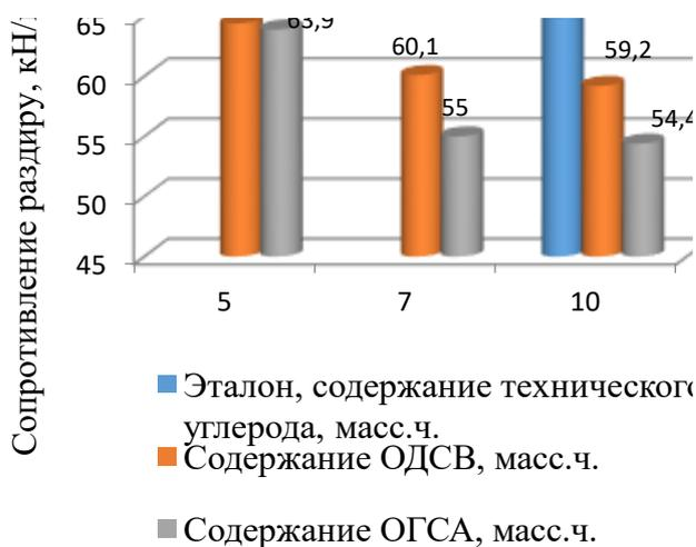
Рисунок 40 - Диаграмма зависимости сопротивления раздиру резины для изготовления подрельсовой прокладки от содержания ОДСВ и ОГСА
