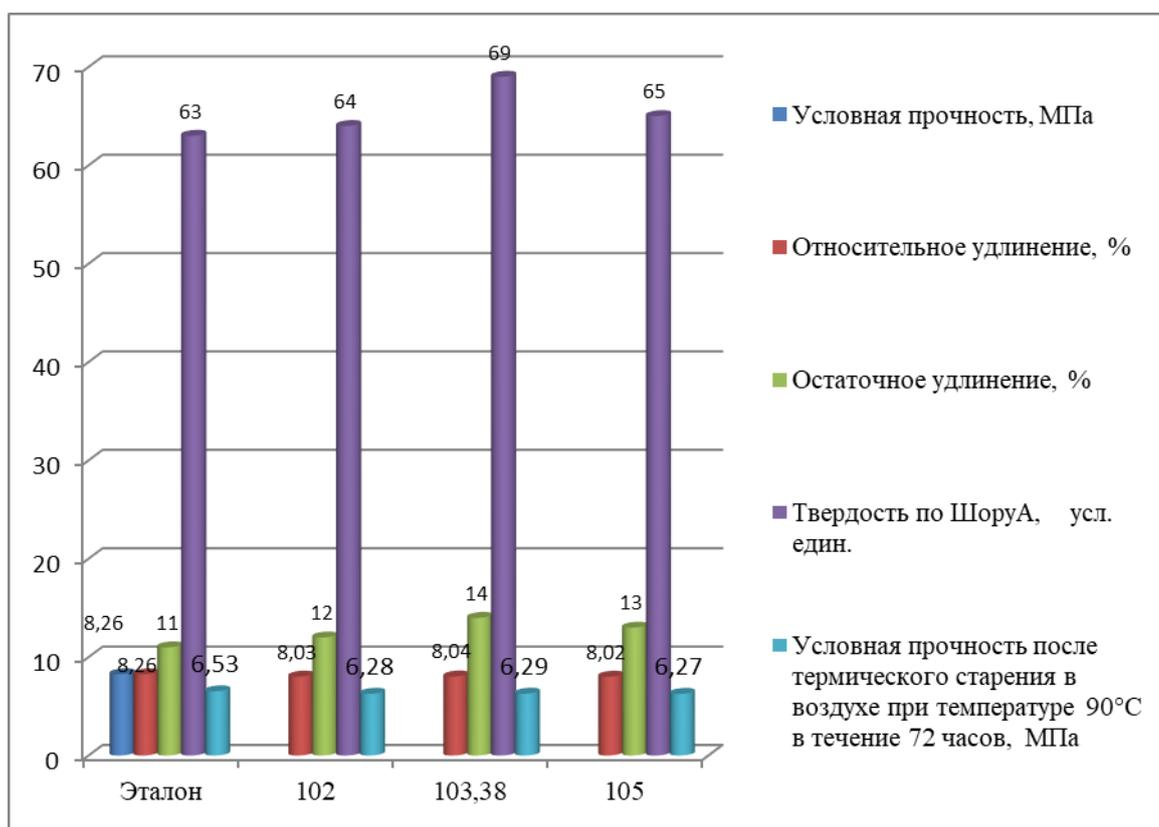
Рисунок 20 - Диаграмма зависимости физико-механических свойств от содержания МШРД
