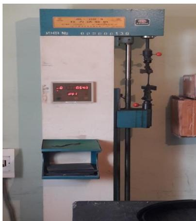
Рисунок 5 – Разрывная машина MPC-2
