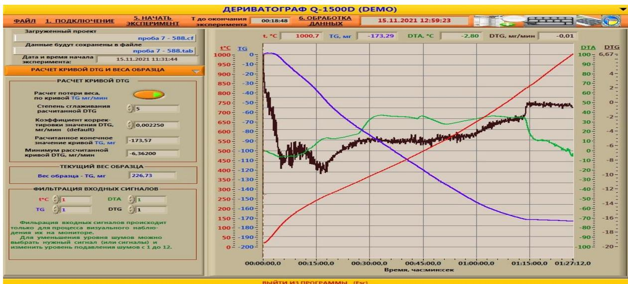
Рисунок 10 - Кривые дифференциально-термического анализа (ДТА), термографиметрического (TG) и дифференциально-термогравиметрического (DTG) анализа образцов ОДСВ ТОО «Арай»
