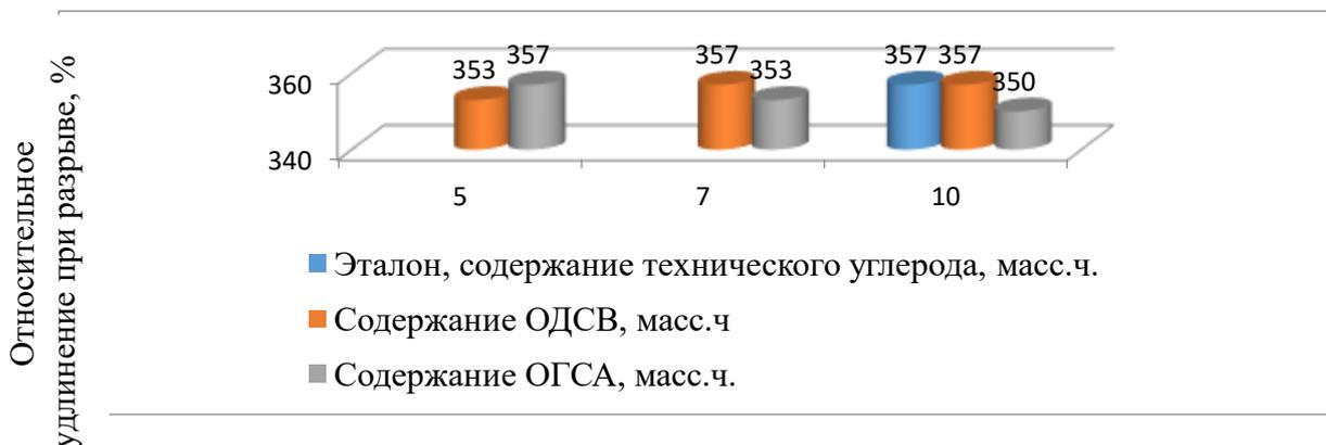
Рисунок 39 - Диаграмма зависимости относительного удлинения при разрыве резины для изготовления подрельсовой прокладки от содержания ОДСВ и ОГСА
