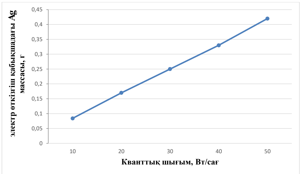
Сурет 3.28 - Электр өткізгіш күміс қабықшасының кванттық шығымы
